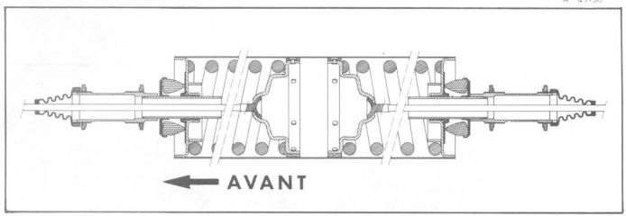
Pots de suspension montés sur véhicules AZ et AZU
